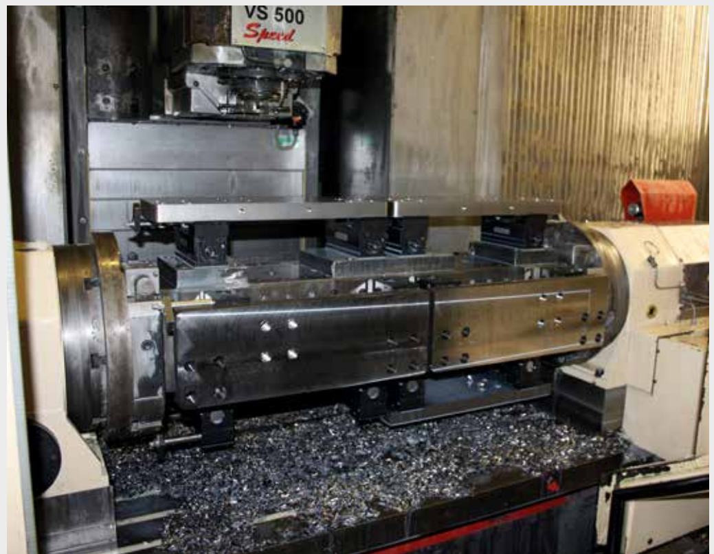
solinos 65 auf Schwenkbrücke Mehrfachspannung von 16 solinos 65 auf grosser Schwenkbrücke solinos 65 on swing bridge Multiple clamping of 16 solinos 65 on large swing bridge increases
