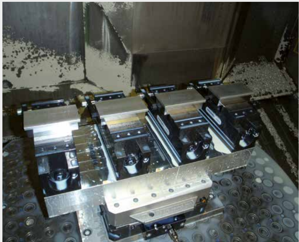
solinos 65 Spannpalette mit 4 solinos 65 zum Spannen von 4 Werkstücken solinos Clamping pallet with 4 solinos 65 for clamping 4 workpieces
