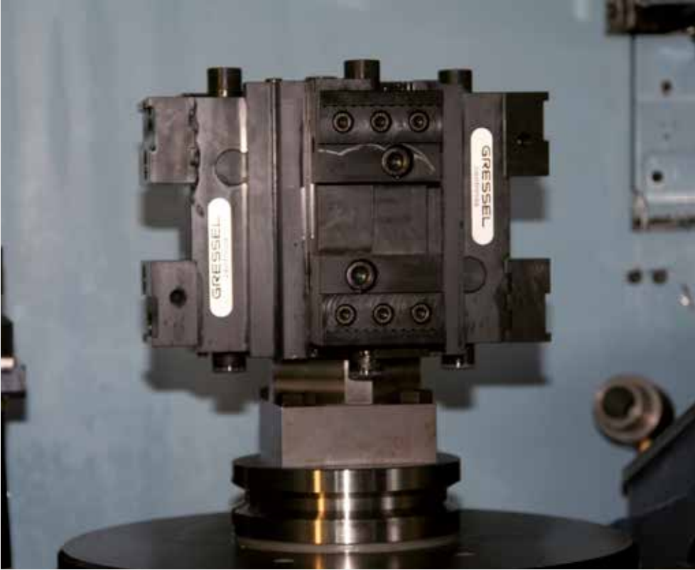
centrinus 65 Turm mit 4 Zentrischspannern auf einer Matsuura Palette centrinus 65 Tombstone with 4 centric vices on a Matsuura pallet
