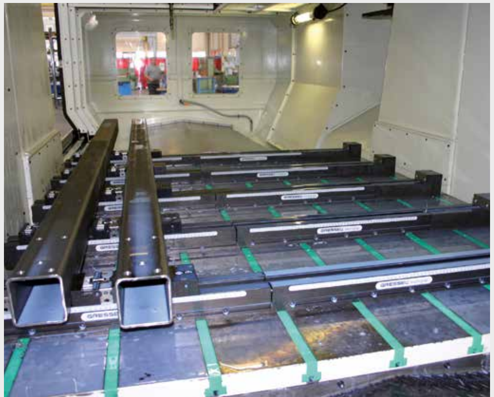
multigrip Maschinentisch komplett bestückt mit aneinandergehängten multigrip Schienen multigrip Machine table fully equipped with connected multigrip clamping rails
