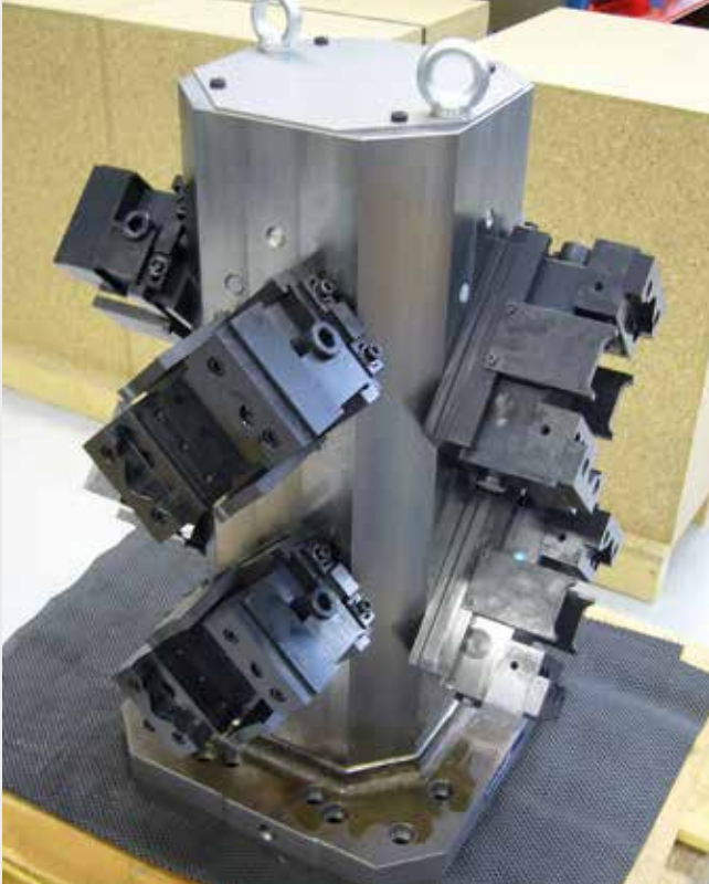
Kreuz-Aufspannturm bestückt mit 8 centrinos 100, Spezialbacken und Werkstückauflagen Cross tombstone Fitted with 8 centrinos 100, special jaws and workpiece supports
