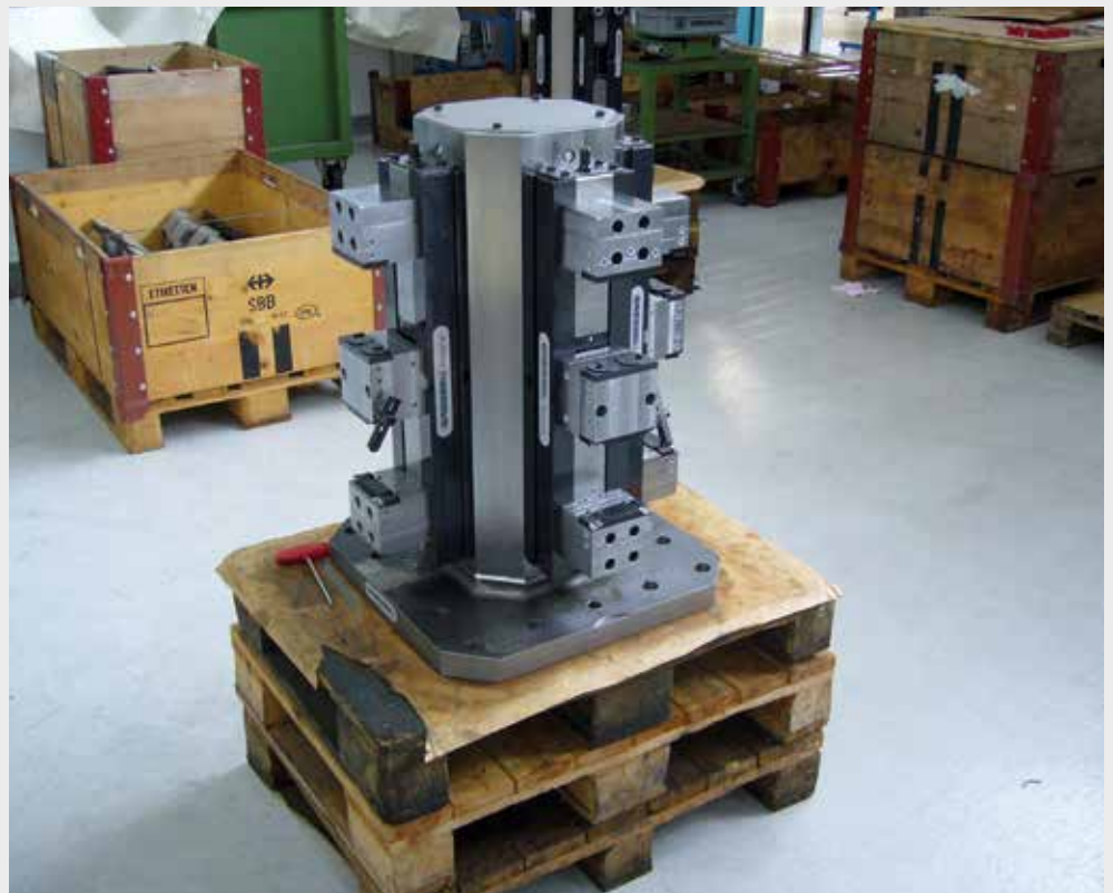
Kreuz-Aufspannturm Bestückt mit 4 duogrip 125/490 und Spezialbacken Cross tombstone Fitted with 4 duogrip 125/490 and special jaws
