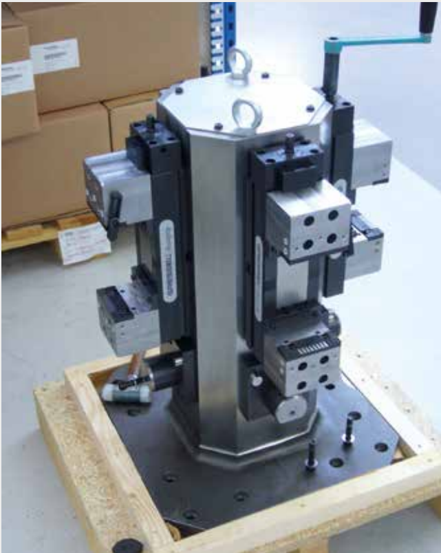
Kreuz-Aufspannturm Bestückt mit 4 duogrip 100/330-C und Spezialbacken Cross tombstone Fitted with 4 duogrip 100/330-C and special jaws
