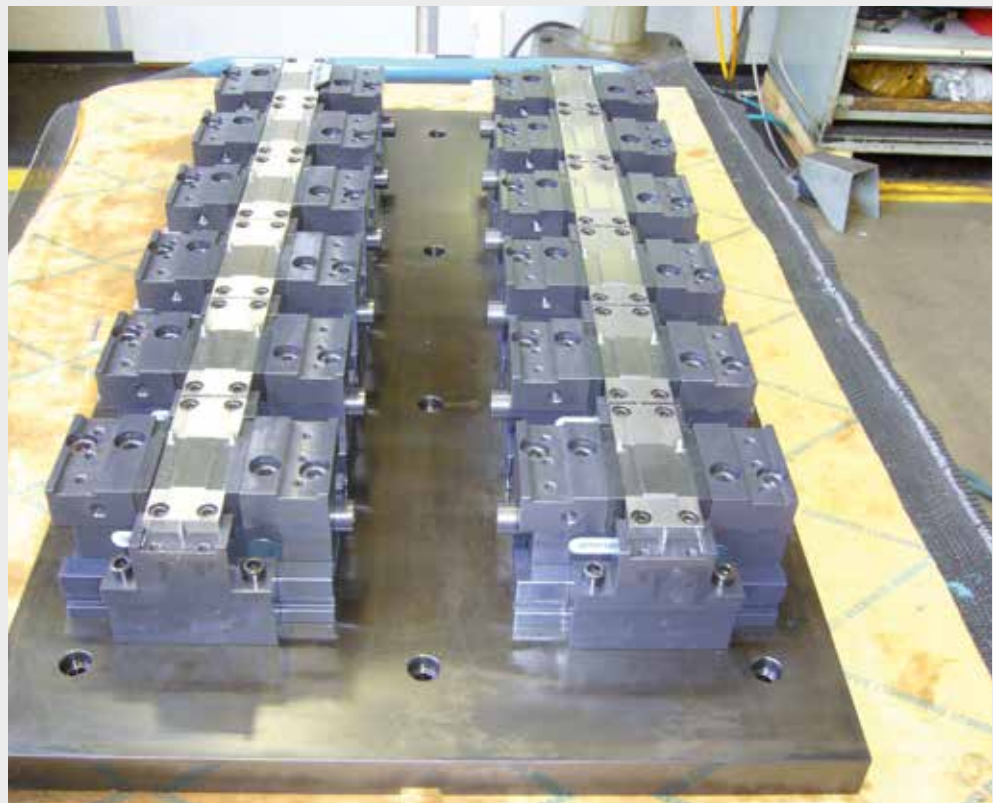
centrinos 65 Mit fester Zwischenbacke zum Spannen von 2 Werkstücken pro Zentrischspanner. Insgesamt 24 Werkstücke pro Palette centrinos 65 Using a fixed intermediate jaw for the clamping of 2 workpieces per centric vice. Total of 24 workpieces per pallet
