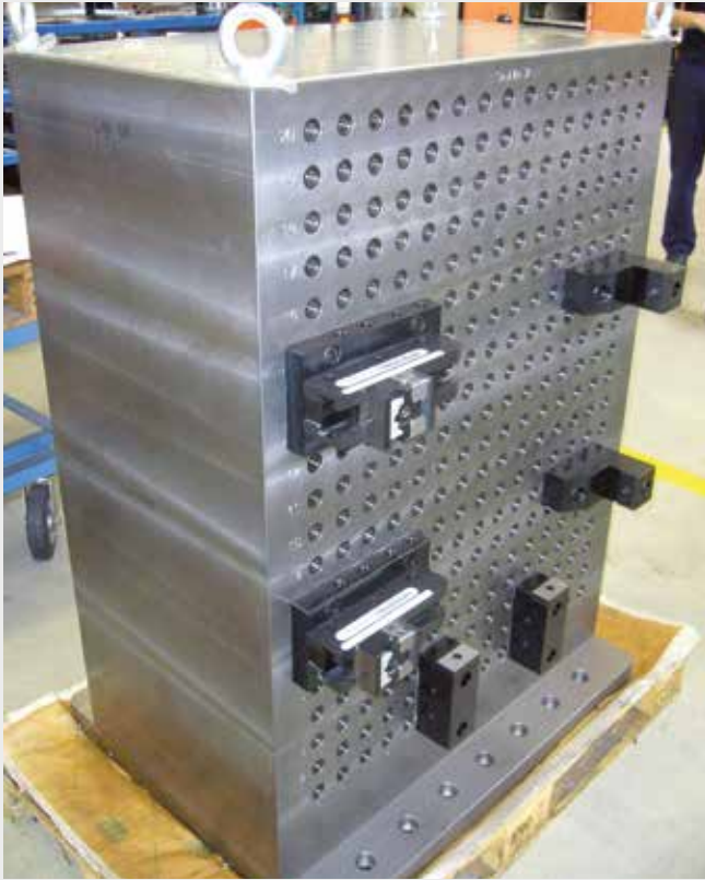
multigrip Getrenntes System auf einem Rasterwürfel zum Spannen von grossen Bronzeplatten multigrip Separately installed system on a tombstone with borehole grid for clamping large bronze plates
