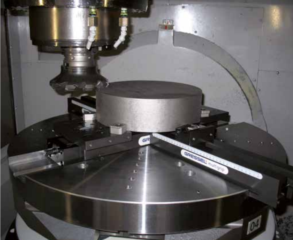
duogrip + multigrip duogrip mit Pendelbacken und 2 multigrip Schienen zum Spannen eines grossen runden Werkstückes duogrip + multigrip duogrip with swivel jaws and 2 multigrip clamping rails for clamping a large round workpiece
