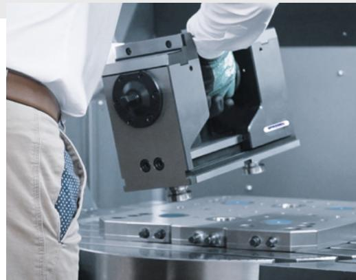
**schnelles Positionieren mit gredoc auf dem Maschinentisch ohne Zwischenplatte**
