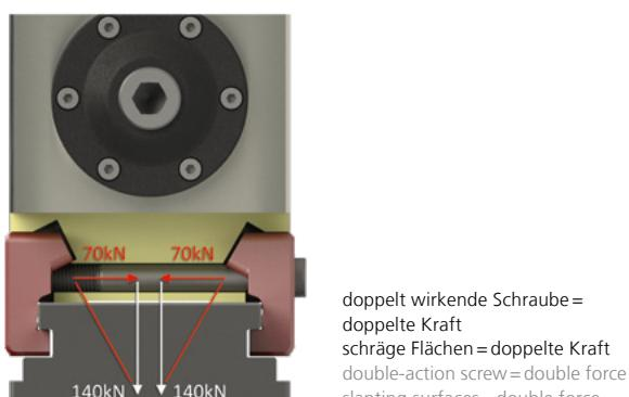
Beim grepos-5X-C und grepos-5X-C-S können beide Trägerbacken beliebig verschoben werden. Die mobile Festbacke kann über  $\frac{1}{2}$  Schrauben (1 = grepos-5X-C / 2 = grepos-5X-C-S) auf jeder beliebigen Position auf dem Grundkörper geklemmt werden (Schraube mit 90 Nm anziehen). Die Haltekraft der Festbacke ist nahezu identisch wie beim grepos-5X, die mit vier Schrauben befestigt ist.
