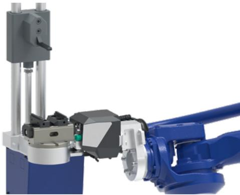
Der Schraubstock für OP20 wird eingelegt
