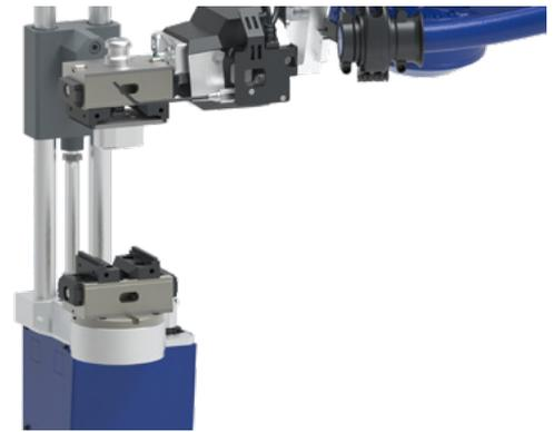
Der Schraubstock von OP10 wird darüber positioniert
