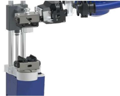
Der Schraubstock von OP10 wird darüber positioniert
