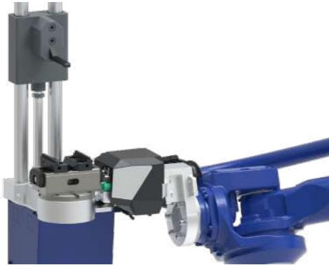
Der Schraubstock für OP20 wird eingelegt
