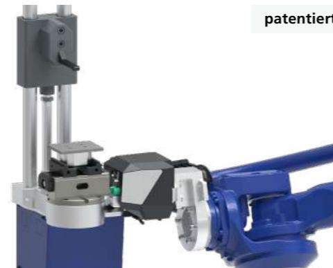
Werkstück für OP20 ist gespannt und Andrückfinger fährt hoch, nachdem das R-C2 Modul das Werkstück vollautomatisch gespannt hat
