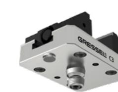
Der C3 L-100 ist mit einer SCHUNK VERO-S NSE mini Schnittstelle ausgeführt. Dadurch kann der Spanner auf NSE mini Modulen sowie Spannstationen mit integrierter Verdreh Sicherung V1 eingesetzt werden.
